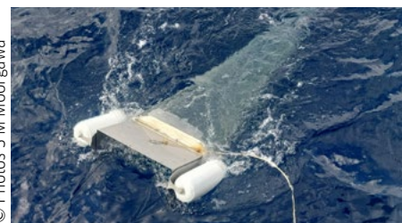
Le "filet manta" déployé depuis le navire Plastic Odyssey sert à collecter les particules de plastique en mer.
